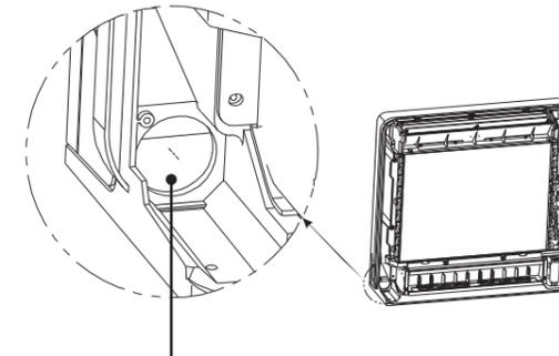
Заглушка отверстия для подключения воздуховода свежего воздуха
