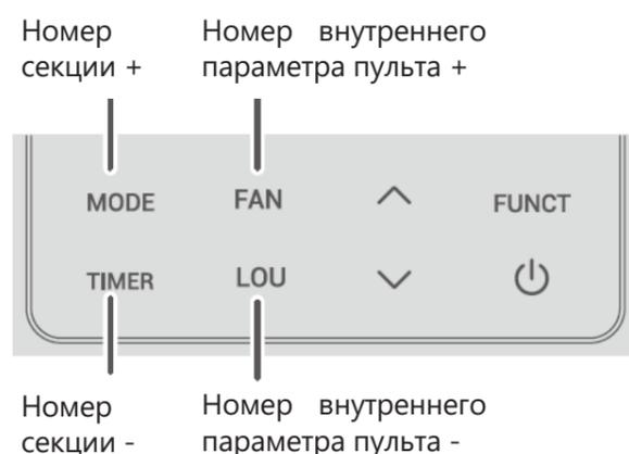
3. С помощью кнопок «**FAN**» и «**LOU**» выберите номер настраиваемого внутреннего параметра пульта (см. таблицу номеров внутренних параметров ниже)
