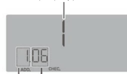
Номер секции    Номер параметра внутреннего блока
