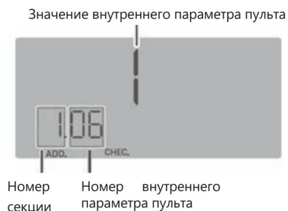
2. С помощью кнопок «**MODE**» и «**TIMER**», выберите номер секции «**1**».
