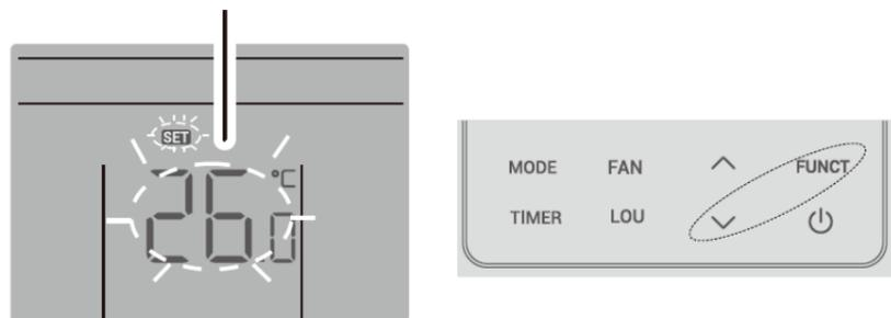
2. С помощью кнопок «**^**» и «**✓**» измените диапазон на желаемый.
