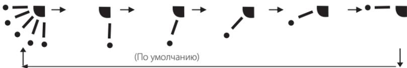
Рис. 37. Последовательность регулировки вертикальной жалюзи
