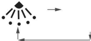
Рис. 38. Последовательность регулировки горизонтальной жалюзи
