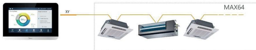
Рисунок 7(b) Соединение пульта ЦУ с внутренними блоками (внутренние блоки переменного/постоянного тока первого поколения)
