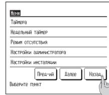
4 При нажатии на кнопку **Назад** (назад) дисплей возвращается на ОСНОВНОЙ экран.
