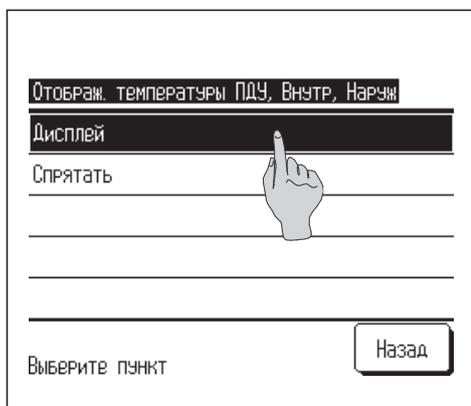
**9** Выберите Дисплей/Спрятать для отображения температуры датчика ПДУ, комнатной температуры и наружной температуры.
