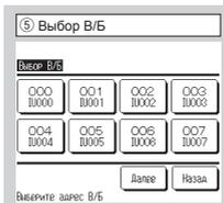
5 **При подключении нескольких внутренних агрегатов выберите В/Б для настроек В/Б.**
