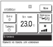
Когда один ПДУ управляется с двух блоков ПДУ, то на вспомогательном блоке ПДУ нельзя выполнить следующие настройки. Необходимо использовать основной блок ПДУ. В случае попытки установить настройки на вспомогательном ПДУ на экране отображается пиктограмма [S].
