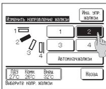
2 Когда отобразится экран Изменить направление жалюзи, нажмите кнопку для выбора нужного направления. Для смены жалюзи нажмите кнопку **Автоматическое качание жалюзи**. Для закрепления положения жалюзи нажмите одну из 4 кнопок.
