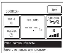
2 На экране ПДУ отобразится сообщение «Режим высокой мощности», и на кнопке «Установка температуры» во время такого режима работы отобразятся символы «—, —°C».
