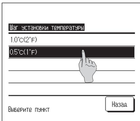
**1** При нажатии «Шаг установки температуры» на экране меню настройки администратора отображается экран **Шаг установки температуры.**
