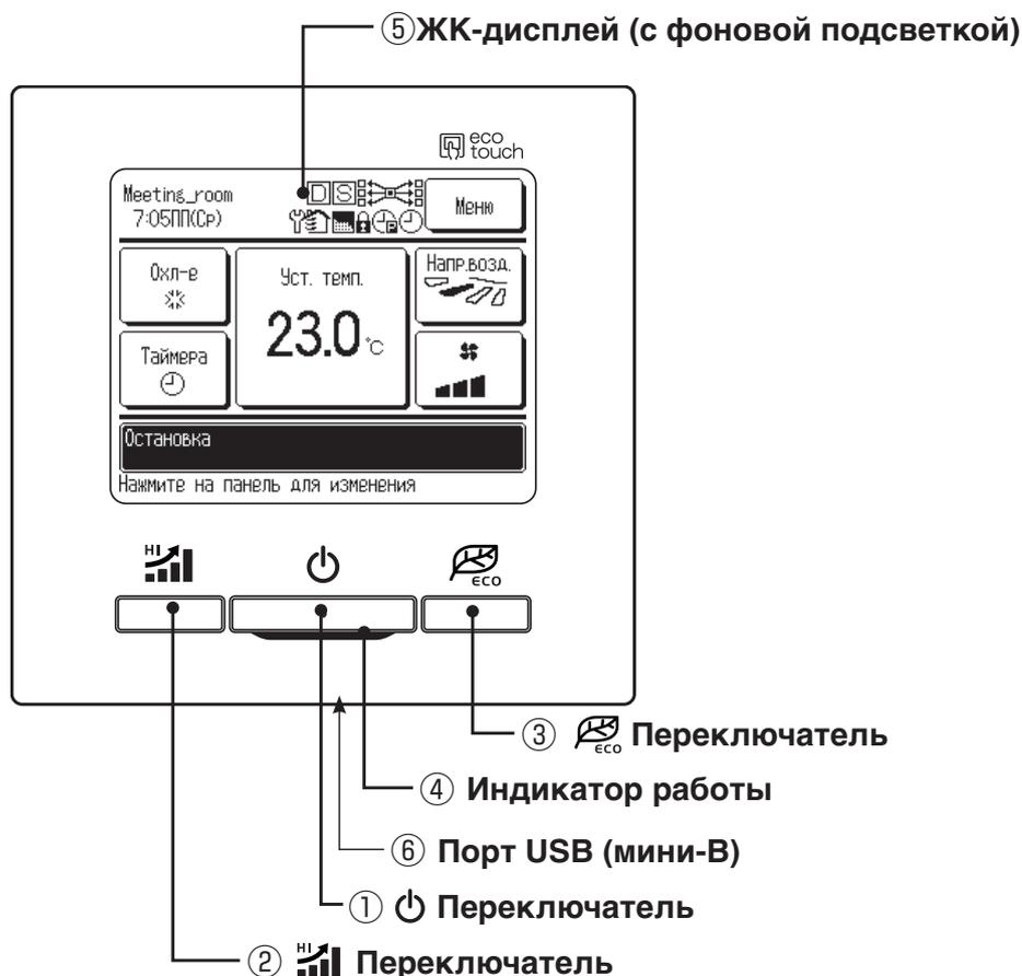
Система с сенсорной панелью, срабатывающая при касании пальцем к ЖК-дисплею, применяется для любых действий, кроме ① – Пуск/стоп, ② – Режим повышенной мощности, ③ – Переключатели режима энергосбережения.
