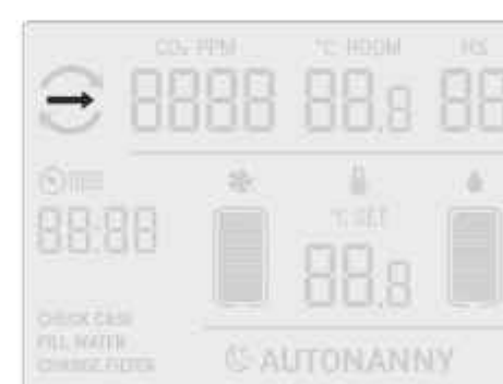
Режим приточной вентиляции. Заслонка 100% открыта.
