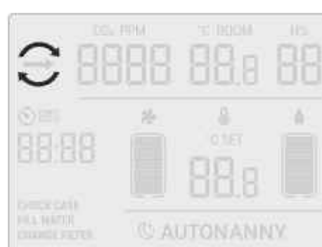
Режим рециркуляции. Заслонка 100% закрыта.
