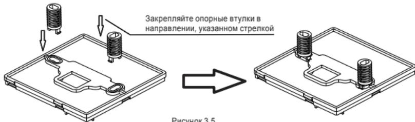
**3-3-4** Возьмите экранированный кабель, заранее заложённый в стену, и проденьте его через отверстие для кабеля, предусмотренное в задней крышке. Винтами с головкой Philips (доп. принадлежность 1) прикрепите заднюю крышку проводного пульта управления к электромонтажной коробке через опорные втулки. Убедитесь в том, что задняя крышка не деформирована после монтажа (см. Рисунок 3.6).
